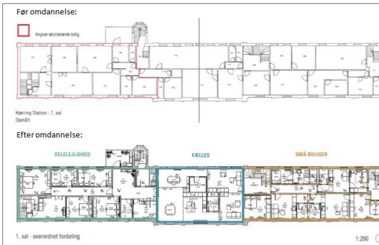
FIGUR 6. Øverst ses plandisponeringen på 1. sal på Hjørring Station før modulforsøget, og nederst ses planen, som den ser ud efter modulforsøget, [Hjørring, C01].
